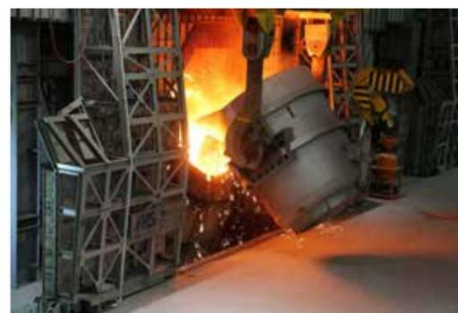
2017年6月1日铁水注入转炉吹炼
